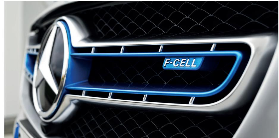
Die folgenden Erkennungsmerkmale zeigen an, dass es sich bei dem an der Einsatzstelle angetroffenen Mercedes-Benz Fahrzeug um ein Fahrzeug mit Brennstoffzellensystem handelt:
