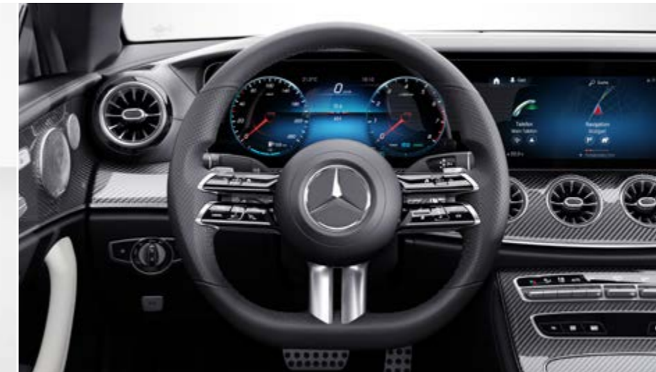
L5C – Multifunktions-Sportlenkrad in Leder Nappa mit Touch-Bedienfeldern und galvanisierten Lenkradschalt paddles
